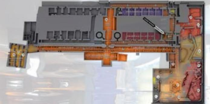
Powierzchnia sufitów napinanych wyniosła 2050 m<sup>2</sup> (80 powłok sufitowych). (prostokąty, kwadraty, trójkąty, trapezy, sufity z łukami) (powłoki montowane na wysokości od 2,20 do 2,95 m)
